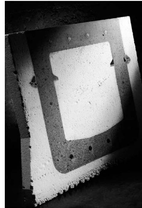
Eco-beton ontwikkeld voor een nieuw type fundering (van B-invented)
