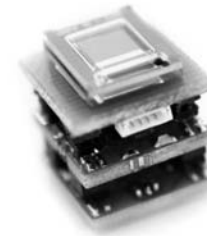
Een micro energiecentrale om elektriciteit op te wekken voor sensoren
