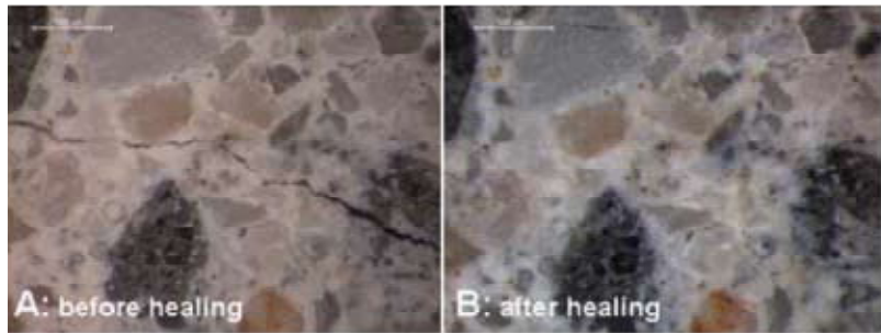
Links beton met een scheurtje, rechts nadat het geheeld is
